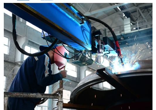
图为贵铝工服引入自动焊取代部分手工作业。 吴奇 摄
